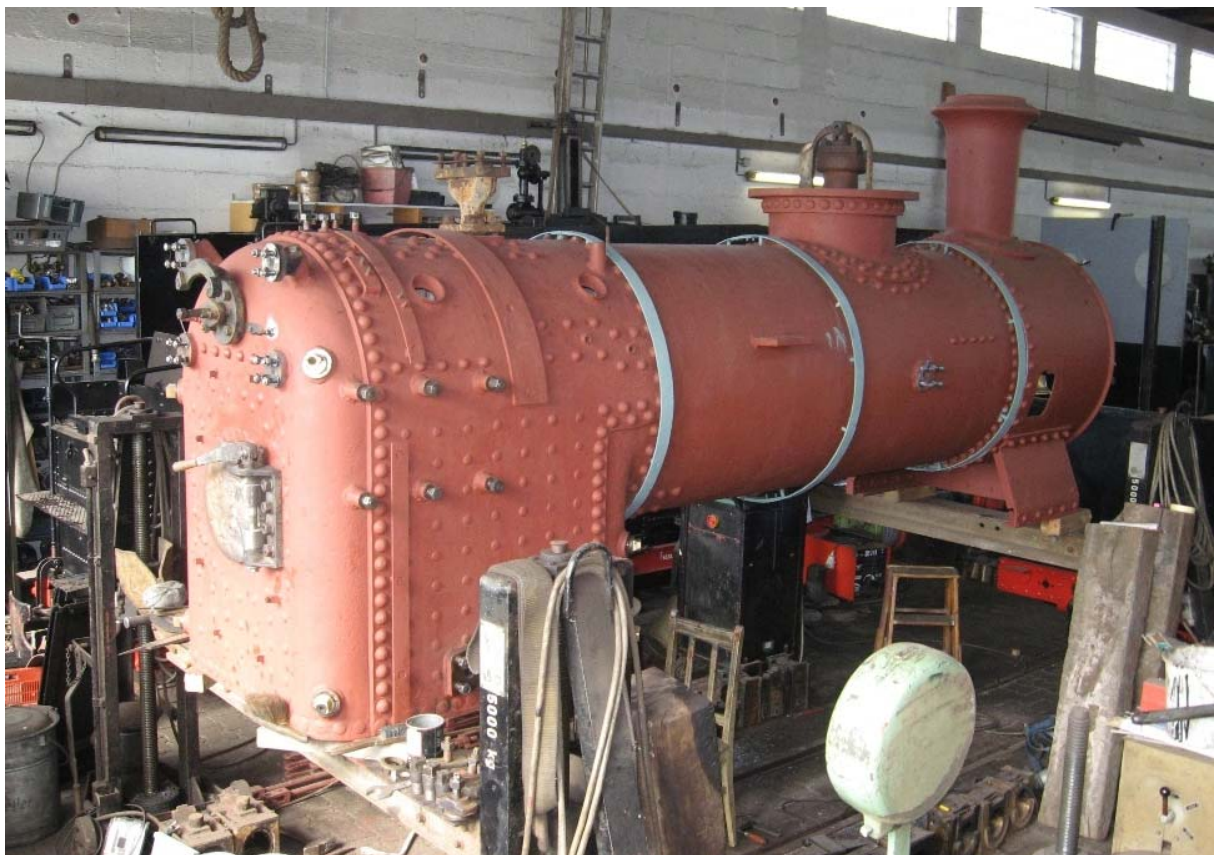
Der Kessel der Lok 11, Jung Typ HF 110C wird für die Wasserdruckprobe vorbereitet Foto: Udo Przygoda, 21. September 2008
