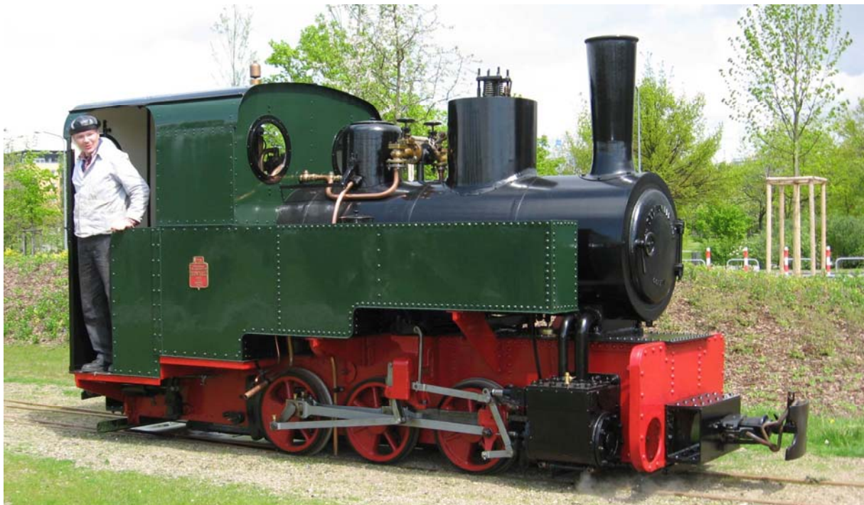
Die Inbetriebnahme der französische Feldbahndampflokomotive Lok 7, Cn2t-Decauville 1593/1915 Foto: Udo Przygoda, 1. Mai 2008
