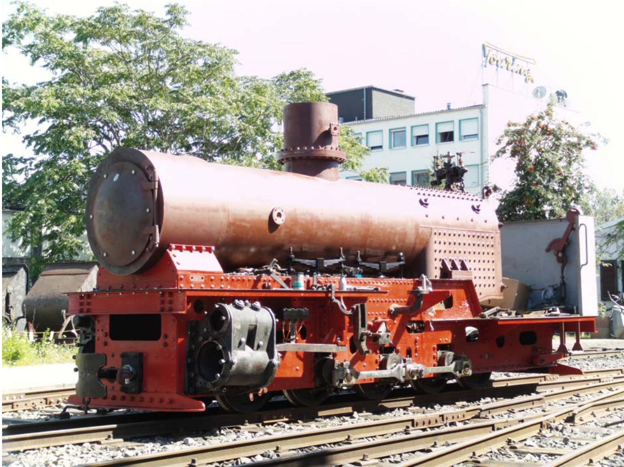
Lok 16 En2t Orenstein & Koppel 11073/1925. Der Neubaukessel und die restaurierten Zylinder sind montiert. Foto: Felix Grassel 18.08.2012
